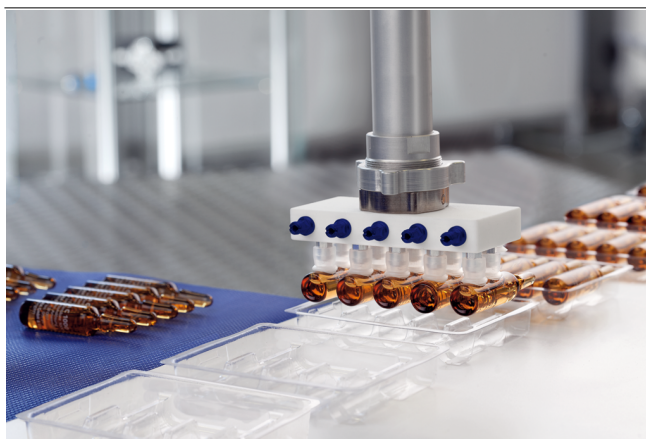
Génération du vide décentralisée par l'ecoPump SEP pour la manipulation des ampoules
